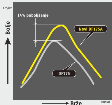
U usporedbi s trenutnim DF175T / 150T, novi DF175A / 150A nude smanjenu potrošnju goriva u cijelom radnom području. DF175A, koji sada uključuje i naš sustav upravljanja Lean Burn i sustav promjenjivog vremenskog otvaranja ventila (VVT), pokazuje smanjenje potrošnje goriva do 14%.
